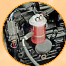
Необслуживаемый топливный фильтр-отстойник
